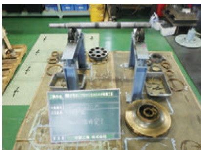
分解とケレン（下地処理）作業が完了しました。
